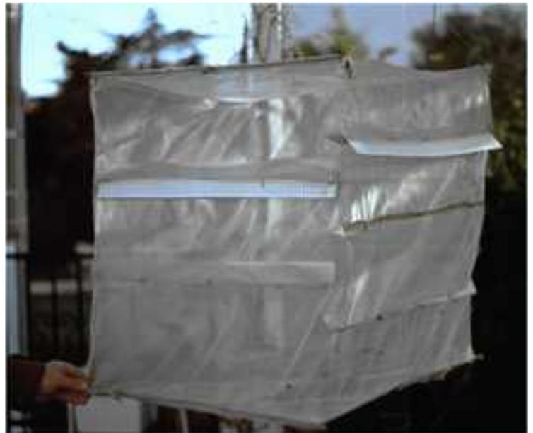
**Fig. 13** - Pièges suspendu en lampion cubique de 60 cm de côté. Deux fermetures verticales à double curseur permettent d'accéder indépendamment au haut ou au bas de la cage.
